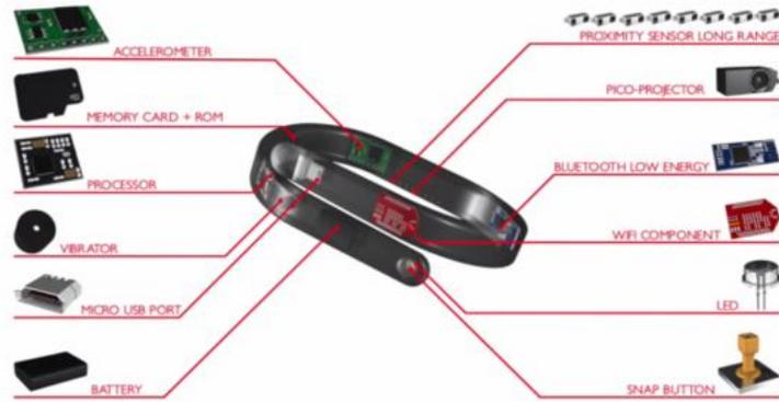
图 2 Cicret 发布的手环结构示意图
